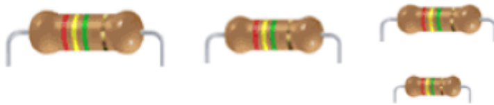
Hình 1.3: Hình dạng thực của loại điện trở 4 vạch màu
