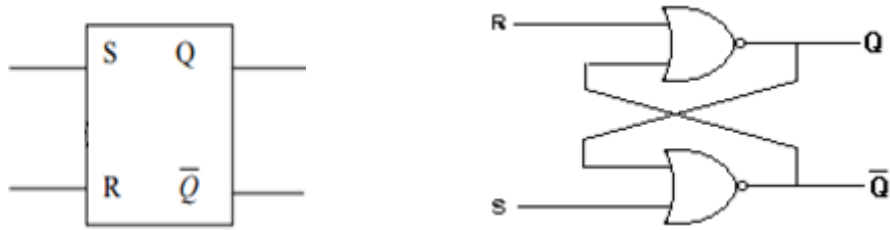
Hình 1.28: Kí hiệu của Flip - Flop
