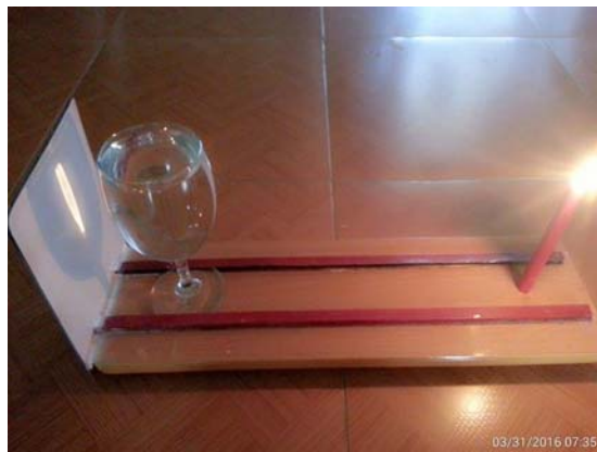
Hình 2.10. Kết quả TN sự tạo ảnh của vật qua thấu kính mỏng.
